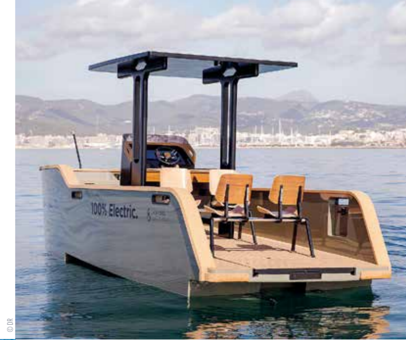
The hull of the Eelex 8000 acts as a semi-hydrofoil, partially lifting out of the water when the boat speeds up. | La coque d'Eelex 8000 agit comme un semi-hydroptère et se soulève partiellement hors de l'eau en fonction de la vitesse.
